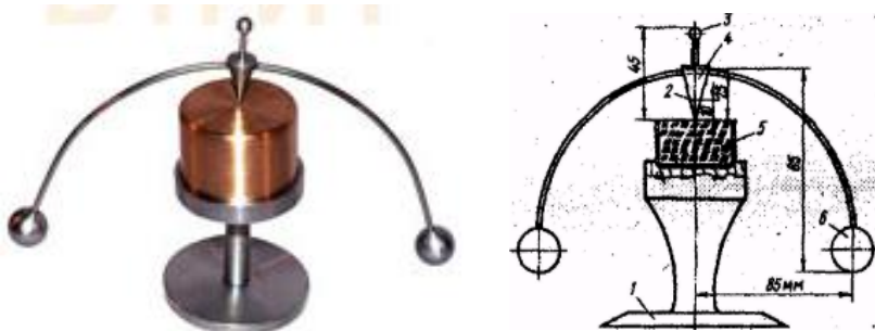
Рисунок 6 - Балансирный конус для определения предела текучести глинистых пород стандартным методом:
